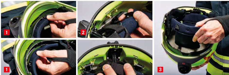
1: Fixierungspunkte vorne 2: Fixierungspunkte hinten
