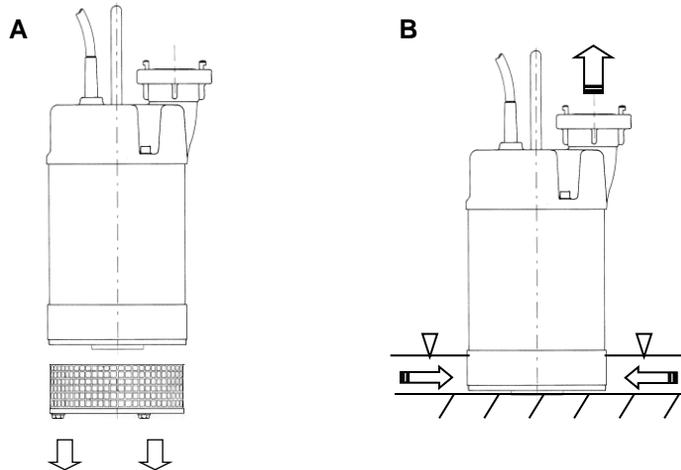
Flachsaugen kann alternativ mit der Flachsaugmanschette (MAST Art. 0603810) durchgeführt werden. Dazu die Flachsaugmanschette bei liegender Pumpe von unten gleichmäßig über das Schutzsieb ziehen und entsprechend der Wasserhöhe ausrichten. Die Pumpe kann so lange absaugen, wie die Sieböffnungen unter Wasser sind.
