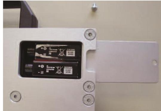
Rückseite: Abdeckung lösen und nach rechts herausziehen
