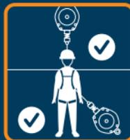
**WICHTIG!** Stellen Sie sicher, dass sich der Verankerungspunkt über dem Benutzer befindet. Überprüfen Sie das Gerät, die Rettungsleine, den Haken und die Verankerung auf Anzeichen von Verschleiß, Verformung, Beschädigung oder Korrosion.
